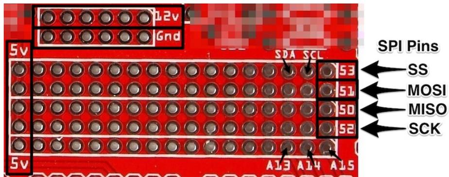
Figure 78: v0\_3\_2\_proto\_annotated.jpg
